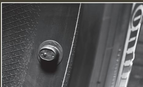
Система ContiPressureCheck непрерывно отслеживает давление и температуру в шине с помощью датчика внутри нее.
