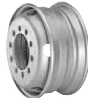
Scheibenrad für Zwillingmontage mit 15° Steilschulterfelge für schlauchlose Bereifung
