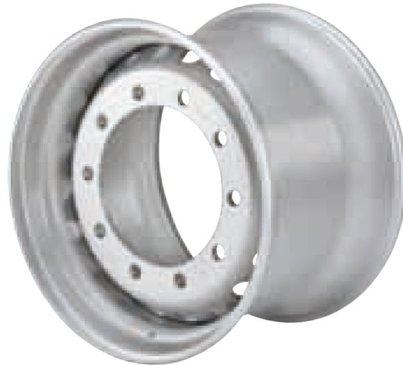
**alive** Scheibenrad für Einzelmontage mit 15° Steilschulterfelge für schlauchlose Bereifung
