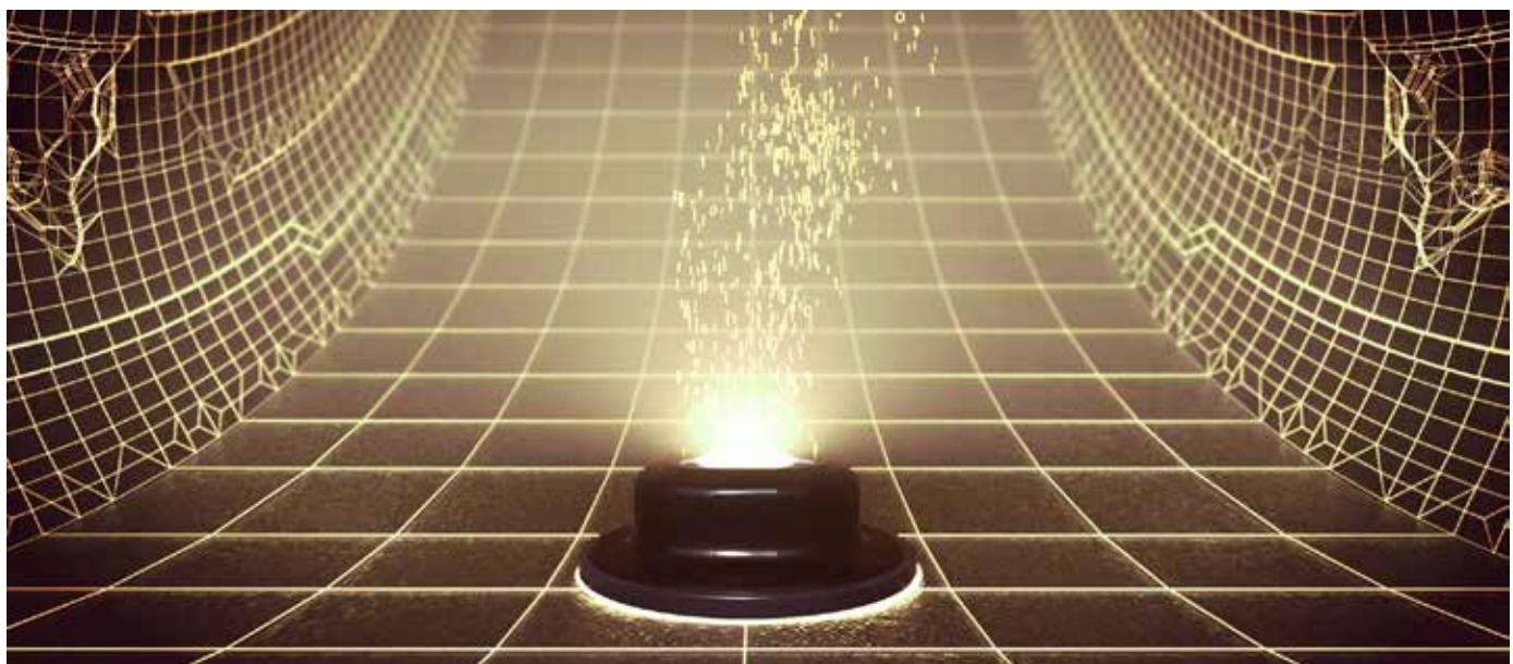
Датчики на внутренней поверхности шин — основа работы цифровых систем контроля шин ContiPressureCheck™ и ContiConnect™. Они непрерывно измеряют температуру и давление в шинах, затем система выводит эти данные на дисплей в кабине водителя и размещает их на веб-портале для мониторинга состояния шин всего автопарка.
