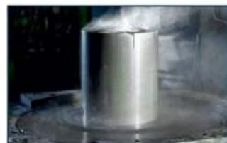
Появлению каждого диска ECO Wheel предшествует его исходный материал в виде отдельного алюминиевого валика из ковкого сплава высокой прочности
